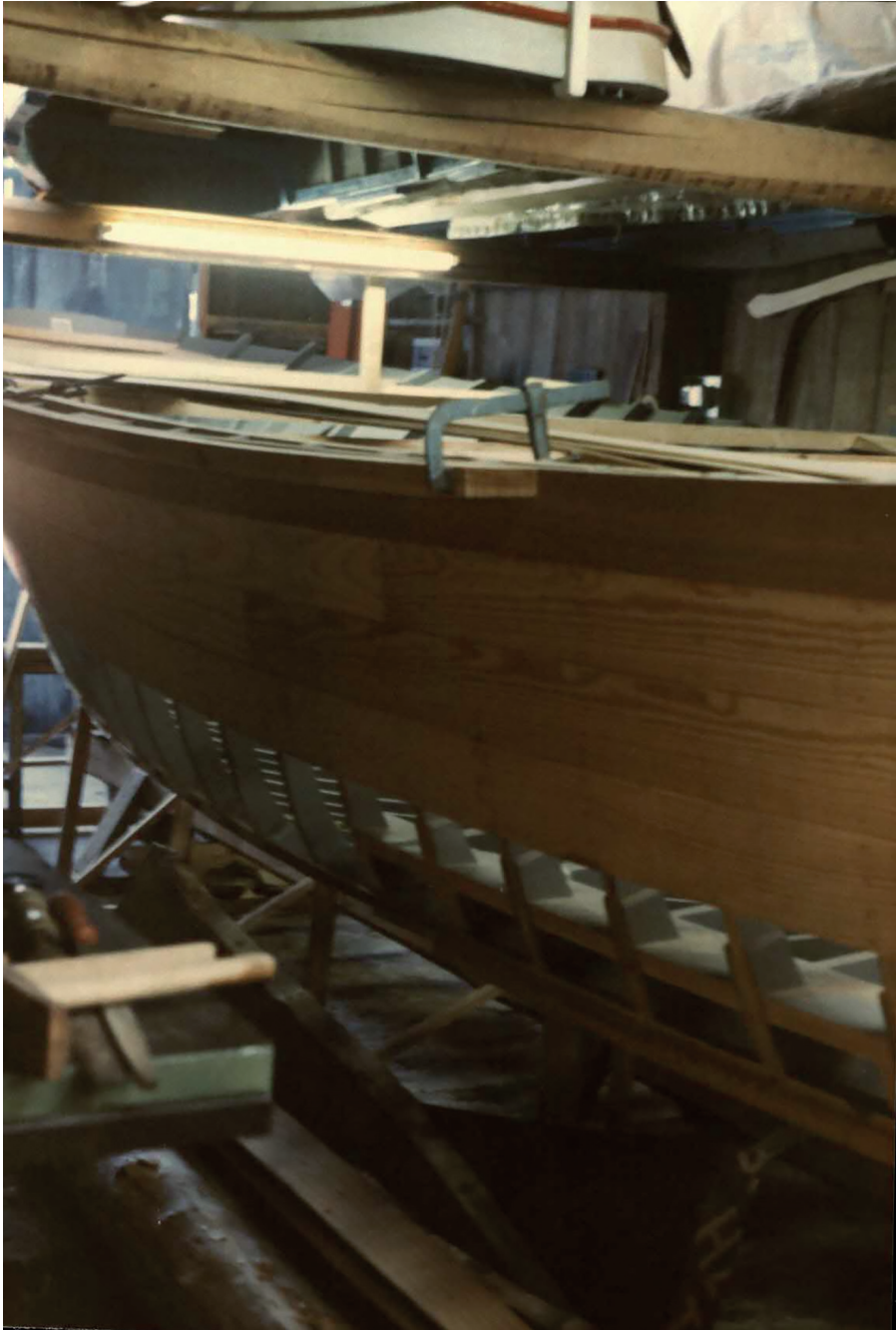
Fasciame dell'imbarcazione al di sotto del quale si evidenziano le costole lignee costituenti l'ossatura del natante
